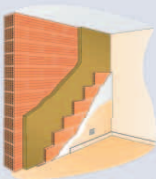
Aplicación del Acustilaine E en tabique cerámico
