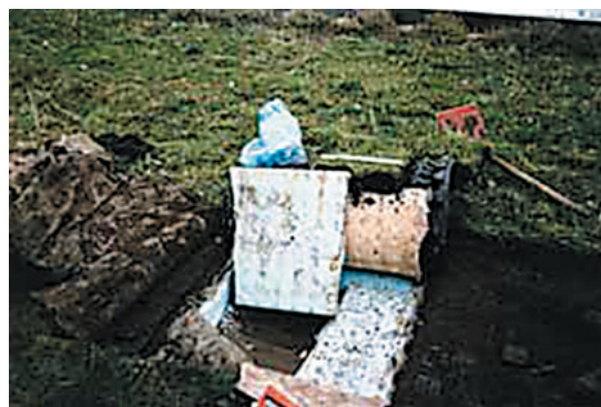
Figura 6. Toma de muestras de placas de ROOFMATE™ de una cubierta ajardinada [Schäfer, von Rekowski, Rahn]
