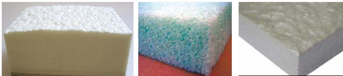
Detalles espumas Poliuretano Celda Cerrada y Celda Abierta Baja y Alta Densidad
