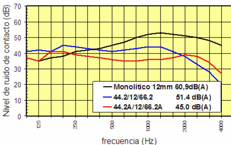
En el acristalamiento monolítico la energía generada por el impacto de las gotas de agua provoca una difusión del ruido. En vidrios laminares, el impacto se amortigua y se transmite peor hacia el vidrio inferior, de manera que la difusión hacia los espacios interiores se atenúa. Comparado con el PVB tradicional, el PVB mejorado forma una capa intermedia menos rígida y de mayor amortiguamiento, disipando así mejor la energía de los impactos de lluvia.
