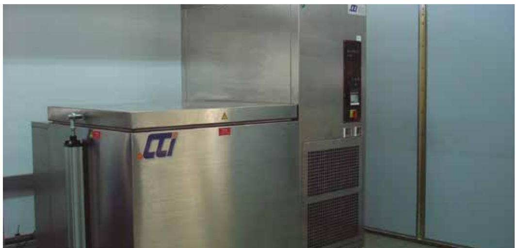
Ejemplos de probetas y equipo del ensayo de ciclos de congelación y descongelación. Imagen cedida por el laboratorio CEIS
