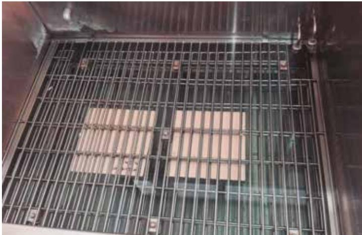
Ejemplos de probetas y equipo del ensayo de absorción de agua por inmersión total. Imagen cedida por el laboratorio CEIS
