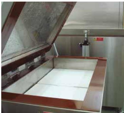
Ejemplos de probetas y equipo del ensayo de absorción de agua por difusión. Imagen cedida por el laboratorio CEIS
