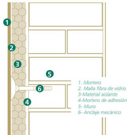
Sección transversal de un SATE mostrando accesorio
