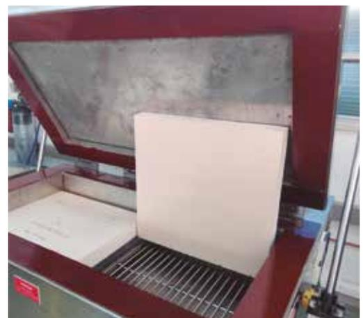
Ejemplos de probetas y equipo del ensayo de absorción de agua por difusión. Imagen cedida por el laboratorio CEIS
