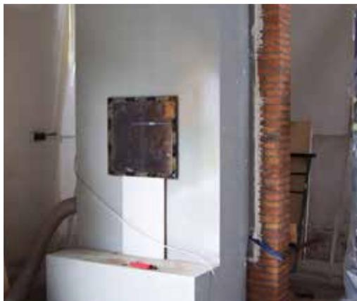
Cajón con rociadores adosado a la muestra de ensayo
