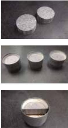
Ejemplos de probetas para el ensayo de transmisión de vapor de agua. Imagen cedida por el laboratorio CEIS
