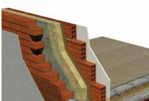
Ejemplo de correcta instalación con la barrera de vapor en la cara caliente
